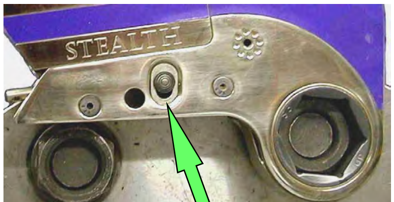
Actionnez le levier de débrayage pour débloquer la clé
